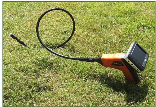
De bij het onderzoek gebruikte endoscoop.
