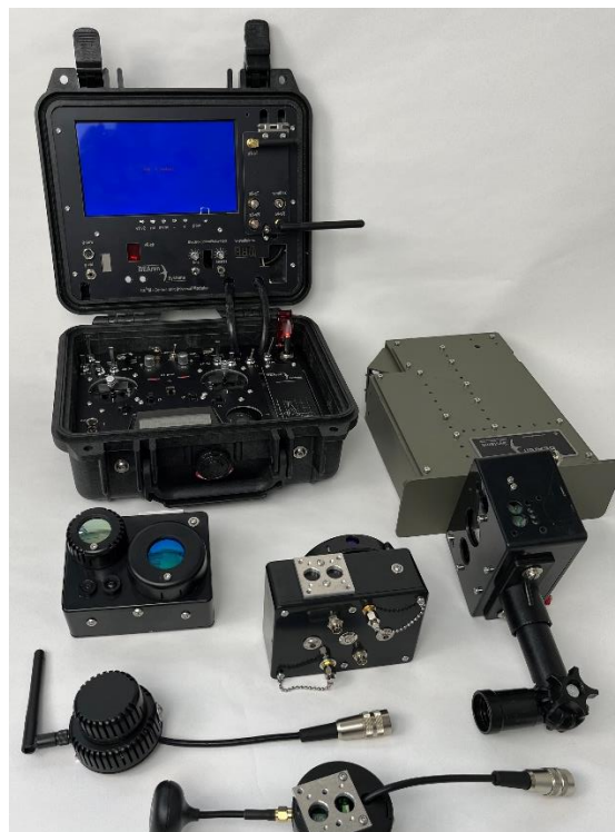
Complete NM 4 set geassembleerd en gereed voor gebruik. Op de foto: control unit, main unit (groen) en de afzonderlijke modules: elektro-optische sensors, akoestische sensors, thermal/infrarood sensors/camera module en HD-camera module. Alleen de mast ontbreekt nog. [foto's: Arno van Eggelen]
