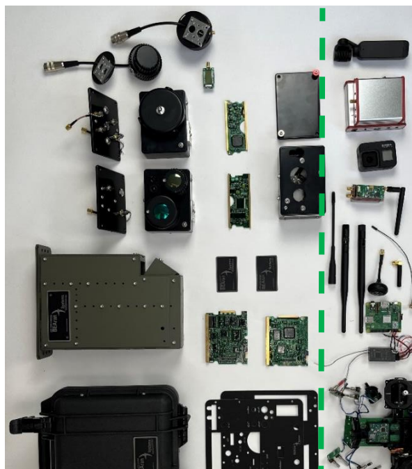
Complete NM 4 set in onderdelen. De PCBA's (printplaten - de elektronica) en behuizingen links van de groene lijn zijn allemaal zelf ontworpen, ontwikkeld en gebouwd. De software/code die op die PCBA's draait is ook zelf ontwikkeld. Rechts de (aangepaste) koopdelen, ook de koffer is een koopdeel en doet dienst als, onverwoestbare, behuizing voor de control unit. De code op de Raspberry Pi minicomputer (rechts, voor de kenner) is, uiteraard, ook zelf geschreven.
