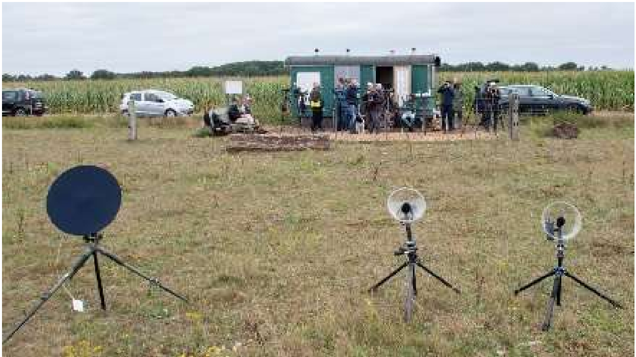
Figuur 3: Drie parabolen met microfoon er in om geluiden op te nemen (foto Martien van Dooren).
